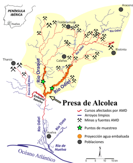
Fig. 1. Contexto geográfico de la presa de Alcolea (Huelva, España). Niveles de afectación de ríos y minas generadoras de AMD. Ver figura en color en versión web.
