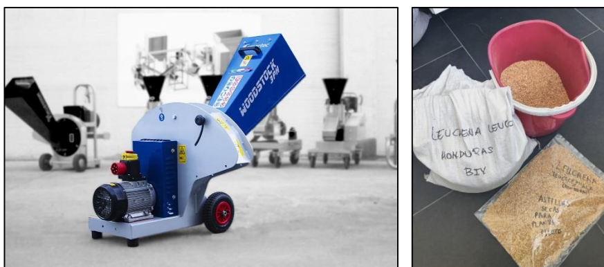
Figura 8. Trituradora Woodstock 3ph (Smartec, Italia) y muestras de L. leucocephala listas para alimentar el reactor de pirólisis de la planta piloto.
