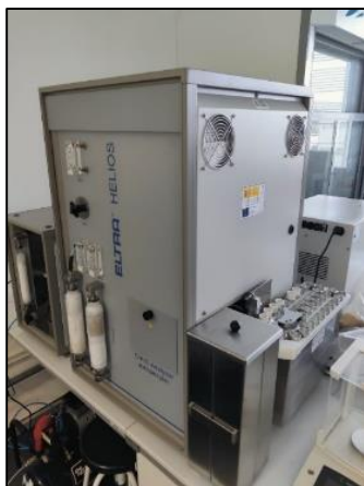
Figura 11. Analizador elemental CHS (Eltra Helios CHS).
