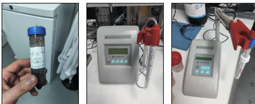
Figura 28. Muestra de bio-oil pirolítico de L. leucocephala obtenida en la planta piloto (izquierda) junto a un conductímetro (centro) y pH-metro (derecha).
