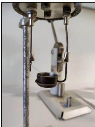
Figura 13. Crisol de las muestras para su análisis mediante calorímetro con fusible.
