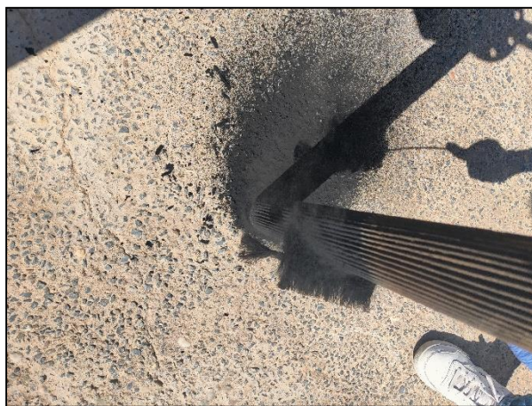
Figura 23. Tareas de limpieza del biocarbón en el filtro metálico de partículas sólidas.
