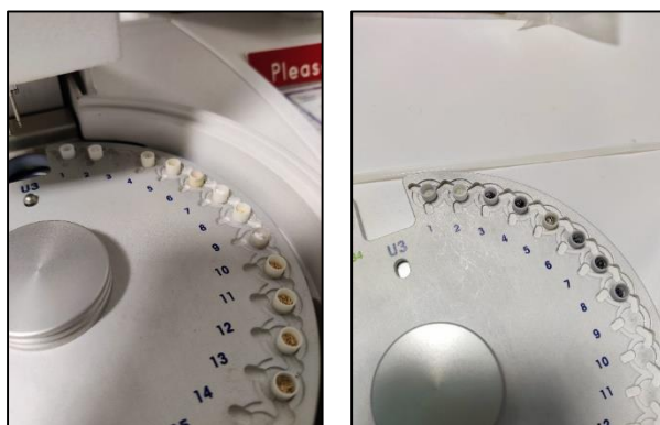
Figura 16. Plato rotativo de muestreo de crisoles del analizador termogravimétrico previo análisis (izquierda) y tras el análisis térmico (derecha).
