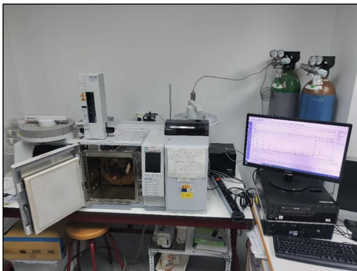
Figura 25. Cromatógrafo de gases acoplado a espectrómetro de masas (GC/MS).
