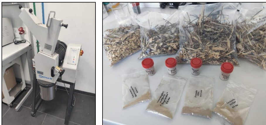
Figura 7. Molino Retsch SM 2000 para muestras sólidas y muestras trituradas para TGA.
