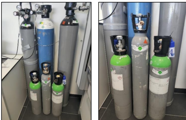
Figura 17. Botellas de nitrógeno y oxígeno en la zona superior. Mezclas de oxígeno al 0,025% (derecha) y 0,075% en peso (izquierda) y dióxido de carbono (centro) en la zona inferior.
