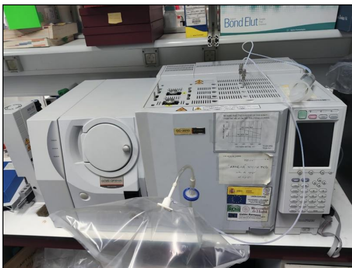
Figura 27. Cromatógrafo de gases con detector de conductividad térmica.
