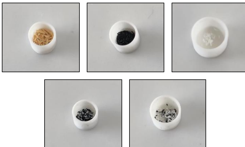
Figura 4. Crisoles de Leucaena leucocephala como materia prima, pirolizada, quemada (arriba) y gasificada al 0,25 y 0,50 de ER (abajo).
