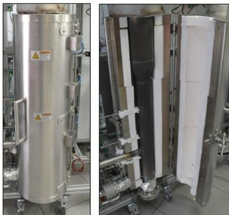
Figura 20. Reactor de lecho fluidizado con horno externo dividido en 3 zonas.
