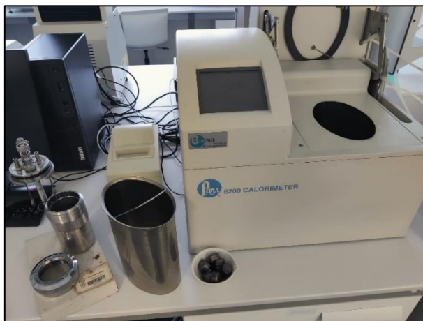
Figura 12. Calorímetro Parr 6200 automatizado con bomba isoperibólica.
