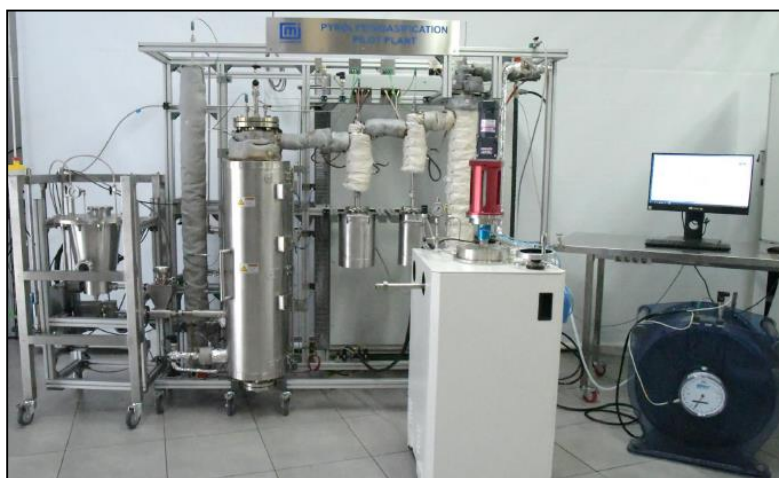
Figura 19. Planta piloto de pirólisis/gasificación con reactor de lecho fluidizado.
