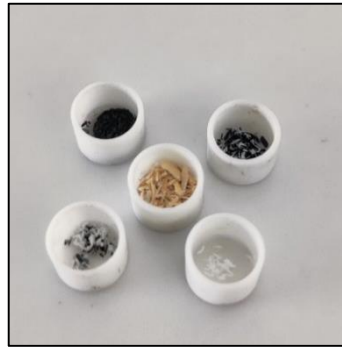
Figura 18. Crisoles con muestras de biomasa y distintos tratamientos termoquímicos en analizador termogravimétrico (pirólisis, gasificación y combustión).
