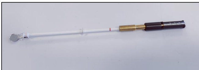
Figura 15. Sensor termogravimétrico de alta sensibilidad para análisis térmicos.
