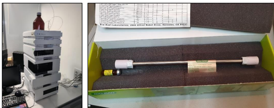
Figura 10. Cromatógrafo líquido de alta eficacia y columna cromatográfica Aminex HPX 87-H.
