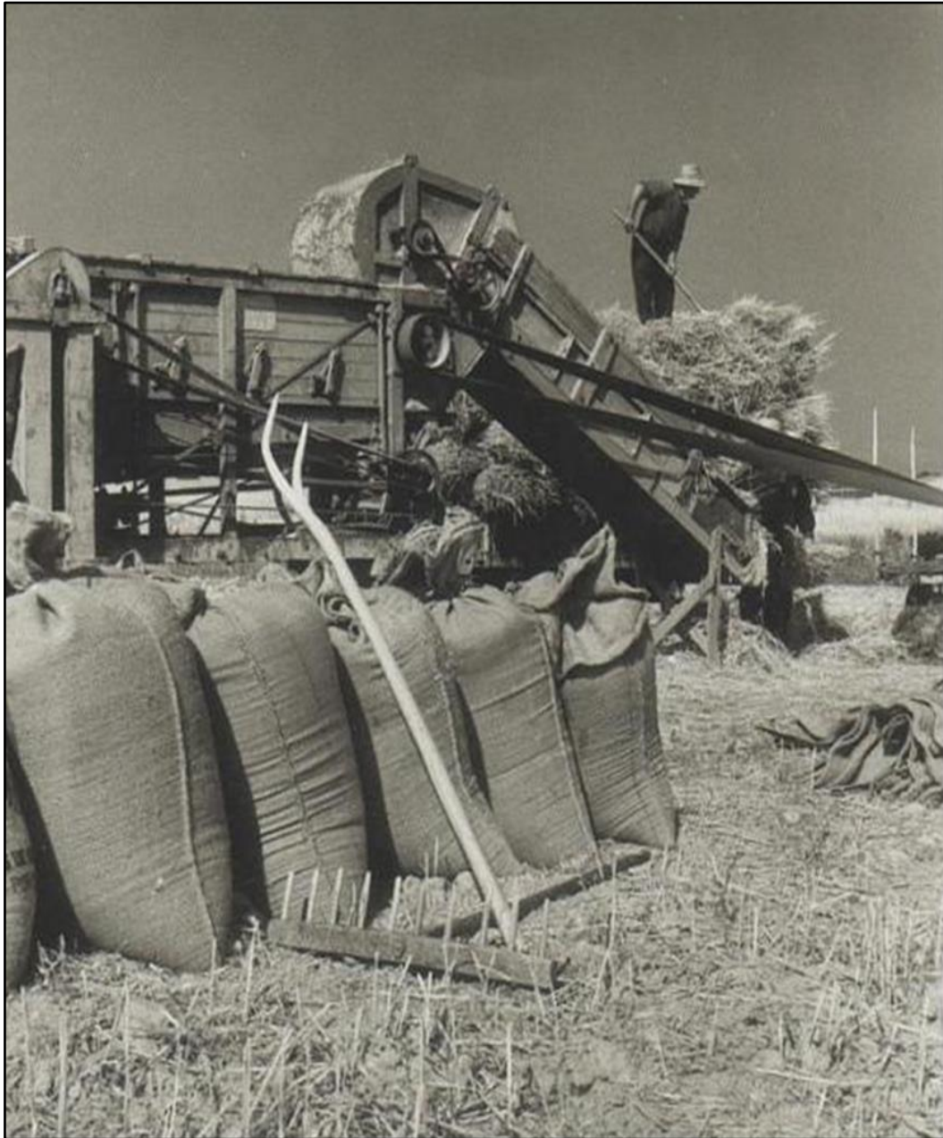
Imagen 3.37.- Trilladora marca AJURIA VICTORIA
