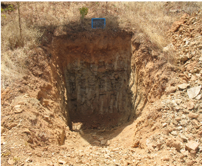
Fotografía 1. Ejemplo de calicatas abiertas por medios manuales (arriba) y mecánicos (abajo), ambas sobre suelos someros. En general, las calicatas abiertas por medios mecánicos precisan un mayor trabajo de preparación del perfil para su observación.
