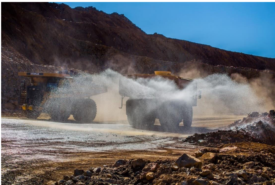
Figura 25. Control del polvo mediante el riego con agua neutralizada con \text{CaCO}_3 proveniente de los procesos mineros. Tomada de Atalaya (2023a).
