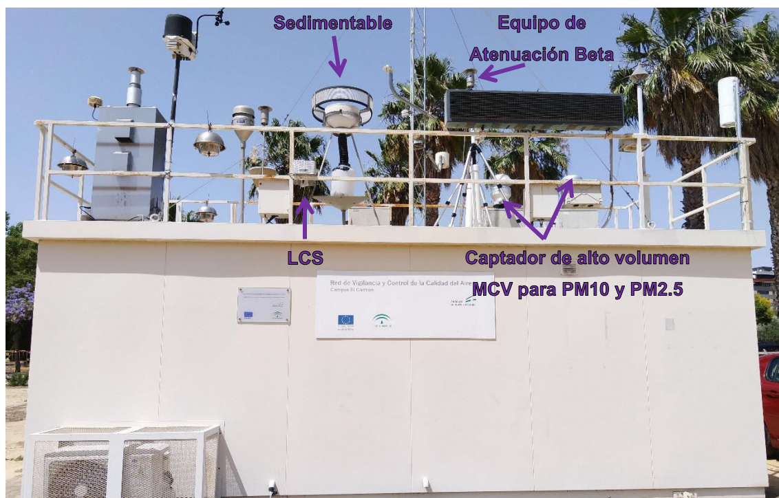
Figura 29. Estación meteorológica con los equipos de referencia y LCS. Fuente propia.
