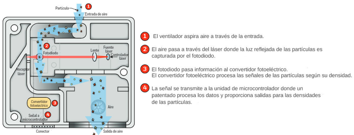
Figura 26. Esquema de sensor de PM. Traducción propia y tomada de Honeywell (2023).
