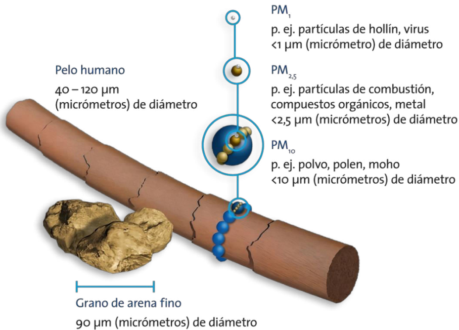
Figura 2. Comparación de tamaño de las partículas de PM. Tomada de Freudenberg Filtration Technologies SE y Co. KG (2021).
