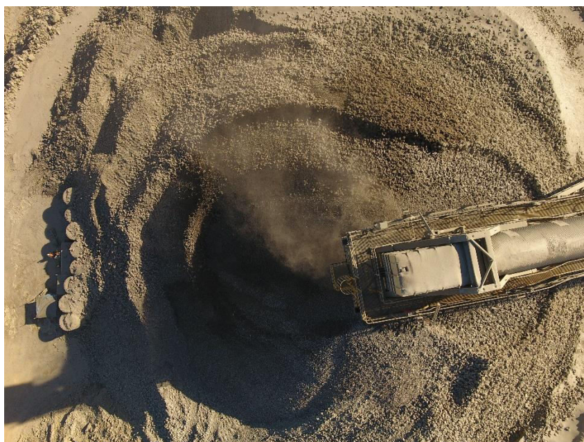
Figura 15. Acopio de mineral en una mina a cielo abierto, donde se aprecia la dispersión del PM por acción del viento. Fuente propia.
