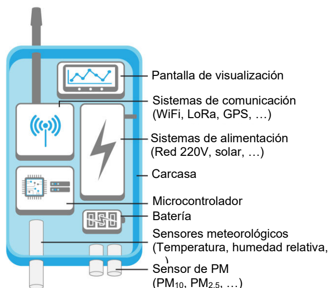
Figura 27. Componentes de un LCS. Traducción propia y tomada de Clements et al., (2022).
