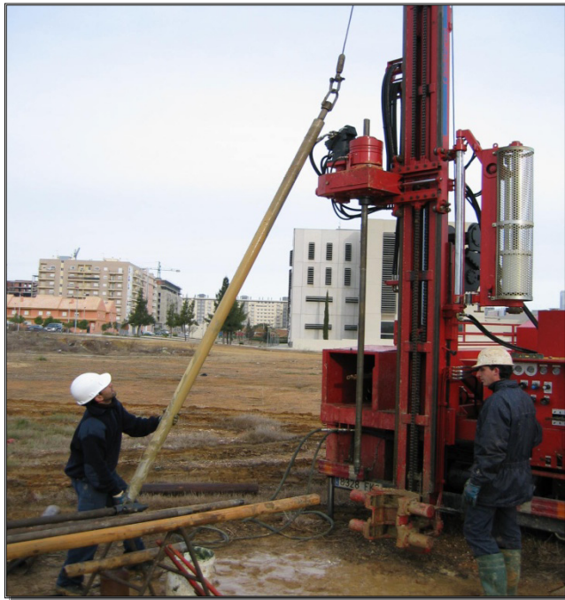
Figura 4. Ensayo de penetrómetro con sondeo realizado para la construcción de la Guardería Infantil de la Universidad de Huelva en el Campus de "El Carmen", donde aflora la Fm. Arcillas de Gibraleón. Abajo se muestra el testigo de los materiales obtenidos.
