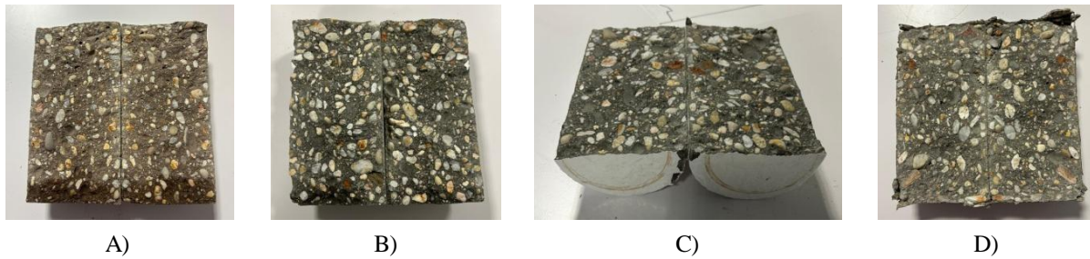
Figura 3: Muestras ensayadas a tracción indirecta mostrando el frente de penetración: A) hormigón de referencia; B) hormigón con fibras; C) Hormigón con poliuretano y D) hormigón con base asfáltica.
