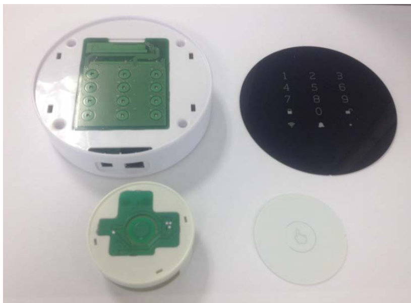
Figura 3.10. Imagen de la estación base y el sensor de gas, y el diseño del encapsulado.
