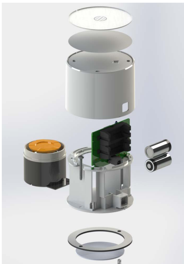
Figura 5.7. Detalle del diseño de la envolvente del nodo actuador.
