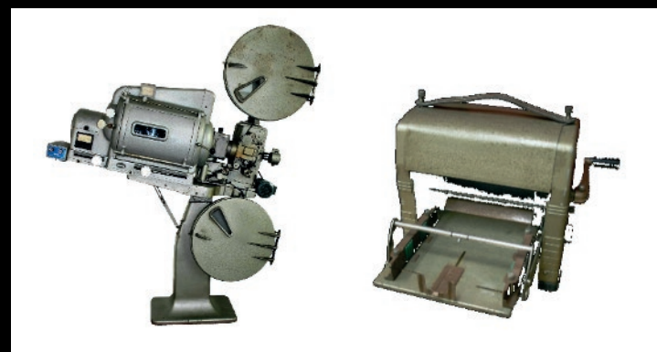
Figuras 13 y 14 | Máquina cinematográfica Proyecson 35 mm; multicopista tipo cyclostyle procedente de la antigua Escuela de Magisterio de Huelva.
