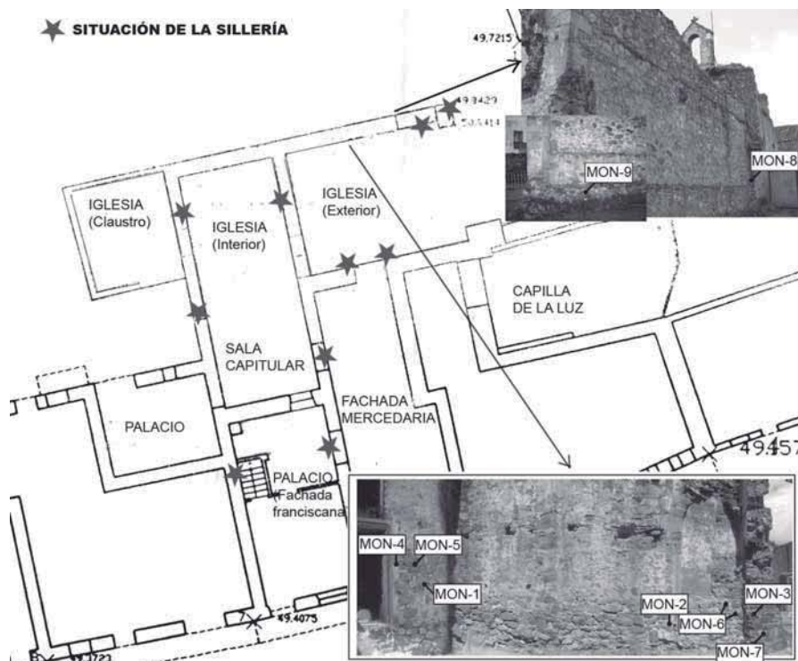
Fig. 2.- Plano de los sectores arqueológicos de la excavación. Situación de la sillería del Monasterio y de la toma de muestras de mampostería en la fachada de la Iglesia Exterior (Modificado del arquitecto Félix Gordillo, proyecto A.R.I.)
