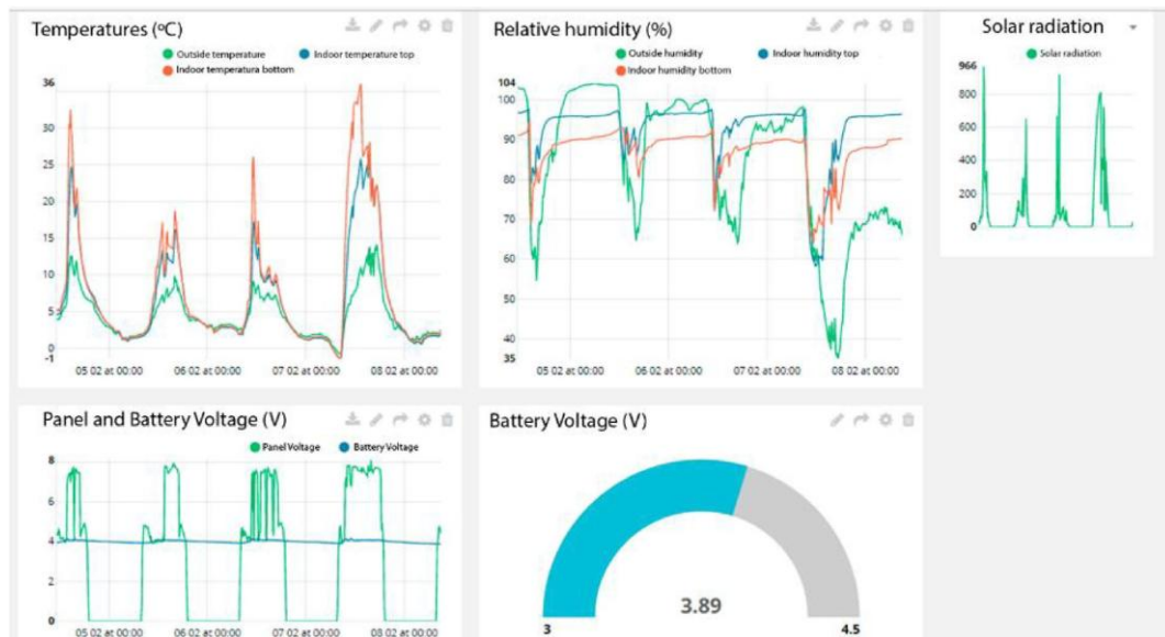
Figura 3. 8 Interfaz de control con representación gráfica de las variables monitorizadas.
