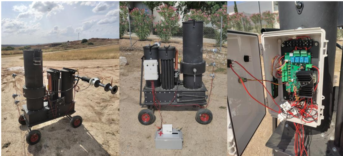
Figura 5. 9 Imágenes del reactor prototipo, incluida una vista de cerca de la unidad de control.
