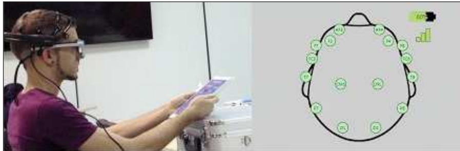
Figura 2. Monitorización simultánea con el EEG y el «Eye Tracking» y posición de los sensores del EEG.
