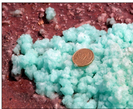
Figura 9. Detalle de las sales eflorescentes precipitadas durante el estiaje que almacenan acidez y metales tóxicos.
