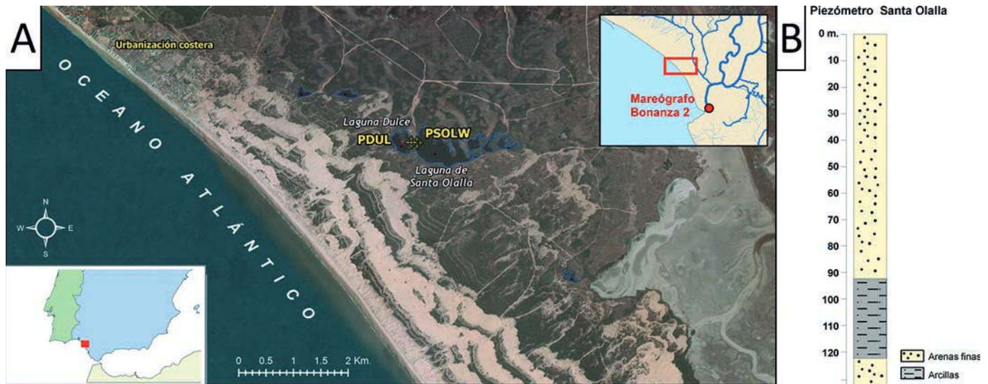
Fig. 1.- A) Ubicación de los piezómetros monitorizados en las proximidades de las lagunas Dulce y Santa Olalla, en un entorno de arenas estabilizadas y a tan solo 2,5 km del Océano Atlántico. En el margen superior derecho se muestra la localización del mareógrafo del cual se han obtenido los datos mareales. B) Columna litológica de un sondeo profundo ubicado en el entorno de Santa Olalla y que sirve de referencia para entender la litología de la zona (modificado de Salvany et al. , 2010)
