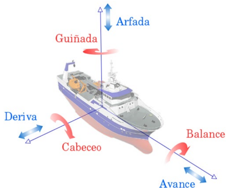
Figura 9. Grados de libertad de movimiento del buque alrededor y a lo largo de su eje longitudinal (balance y avance), transversal (cabeceo y deriva) y vertical (guiñada y arfada).
