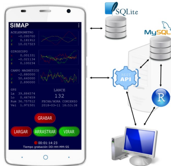
Figura 2. Interfaz de usuario de la aplicación móvil y flujo de información entre el dispositivo móvil, la base de datos local SQLite y la base de datos MySQL del servidor, y entre RStudio y la base de datos MySQL del servidor.
