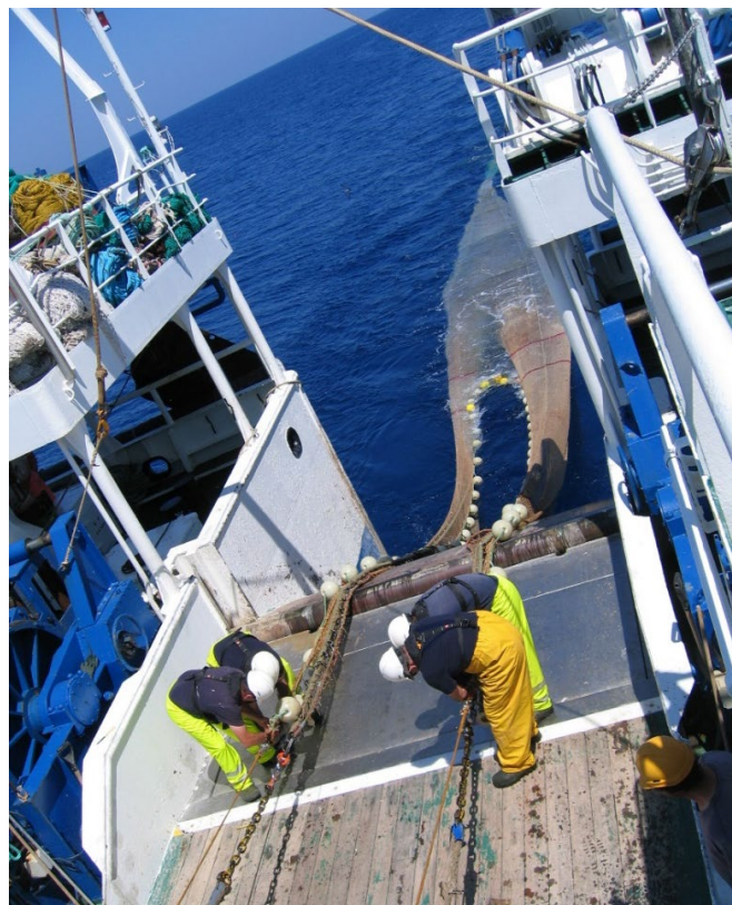
Figura 6. Maniobra de largado de arte de pesca de arrastre en el buque Miguel Oliver durante la campaña MEDITS del año 2016.
