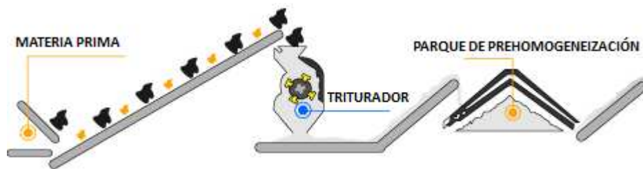
Figura 6.1. Esquema de la obtención y preparación de las materias primas.
