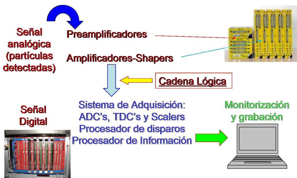
Figura 1.19: Esquema representativo de los diversos componentes de la cadena electrónica y digital utilizada corrientemente en un experimento de detección de partículas cargadas. En la imagen pueden apreciarse ejemplos de Preamplificadores y Amplificadores de Mesytec, además de tarjetas ADC's y TDC's de la empresa CAEN.
