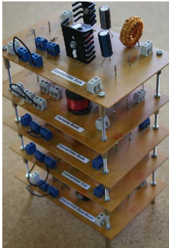
Figura 4.8 Fotografía de los convertidores Zeta, Buck, Variante Buck, Cuk y Buck-Boost.
