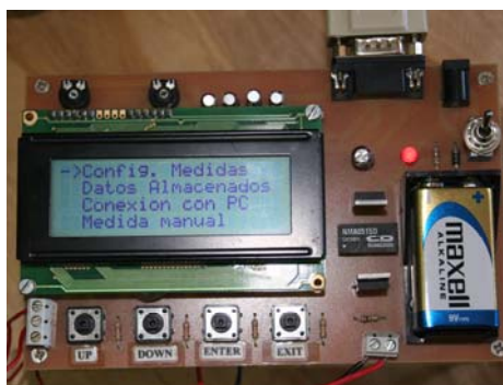
Figura 4.12 Fotografías del sistema de medida con pantalla LCD.
