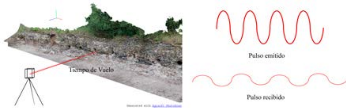
Figura 4. Esquema básico sobre el sistema de medida láser.
