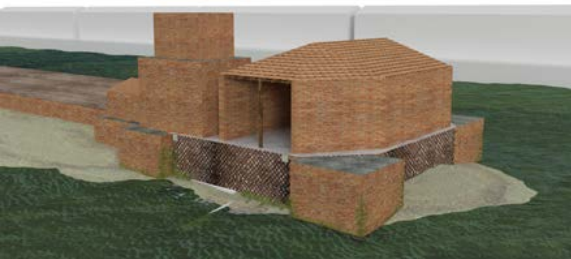
Figura 30. Restitución 3d de las últimas reformas del puntal con el adosamiento de una cuarta plataforma auxiliar y la construcción de un nuevo espacio portuario.
