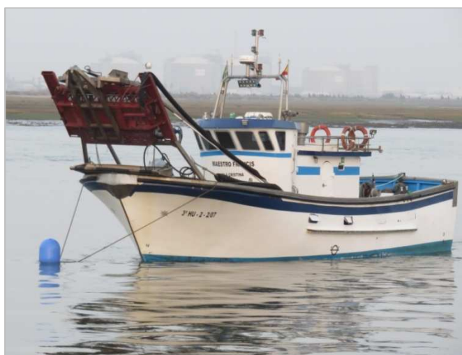
Figura 5.4. Embarcación con draga hidráulica izada
