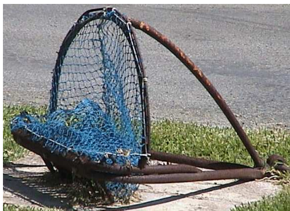
Figura 5.2. Rastro remolcado tradicional de púas con red de malla
