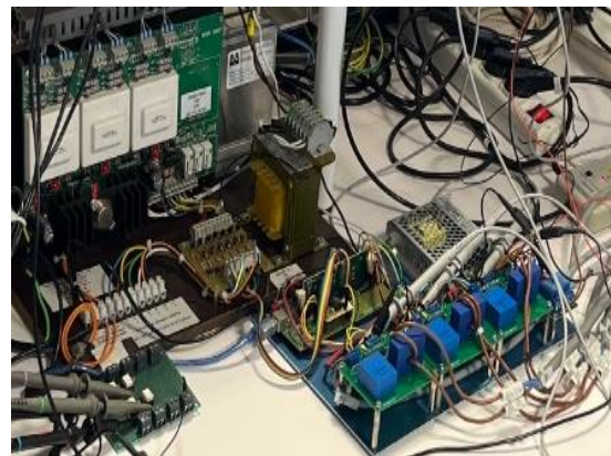
Fig 3. Bloque de medida, tarjeta DSP y etapa de potencia del inversor
