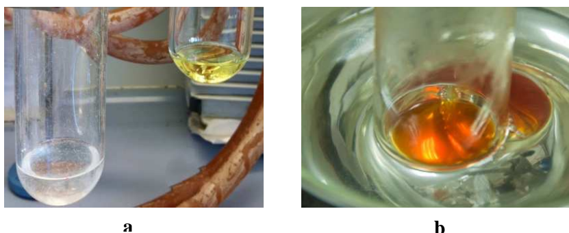
Figura 21. (a) Complejo 1 (disolución incolora) y diazoacetamida de N,N-dietilo (disolución amarilla). (b) Mezcla de la reacción (disolución naranja).
