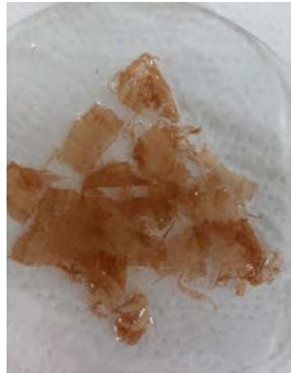
Figure 19. Planos transversales recién cortados, con un grosor de 20 a 30 micras.
