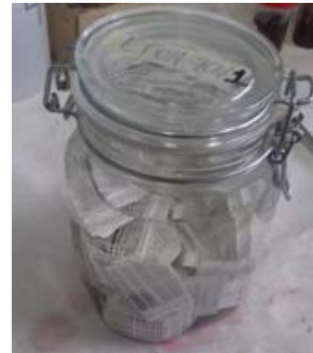
Figura 22. Inclusión en Alcohol 70% de las muestras en cajetillas que se usarán para realizar posteriormente los cortes en el microtomo.
