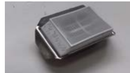
Figura 23. Molde con la muestra en el interior sumergida en parafina que se endurece.
