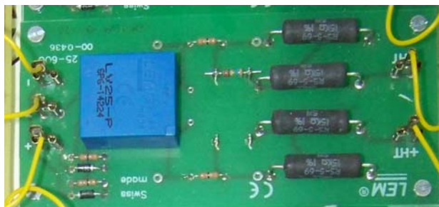
Fig. A.17. Sensor de tensión LV25-P
