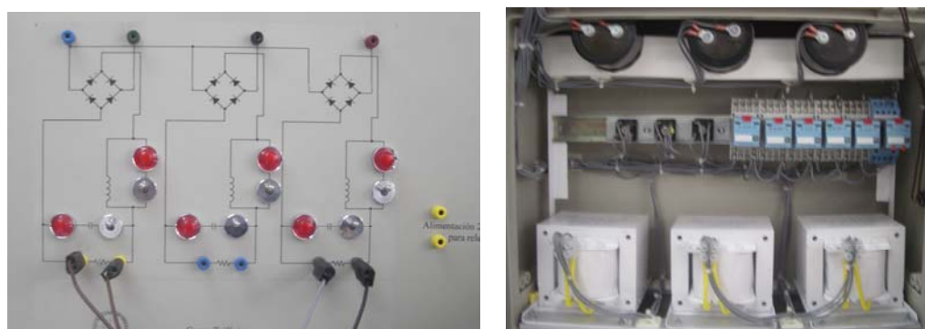
Fig. A.4. Carga trifásica no lineal formada por tres rectificadores monofásicos no controlados
