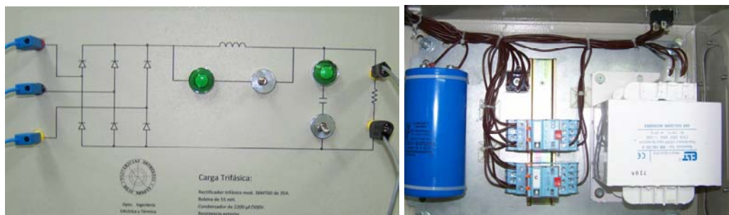
Fig. A.3. Carga trifásica no lineal formada por un rectificado trifásico no controlado
