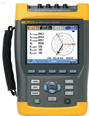
Fig. A.20. Analizador de redes Fluke 434
