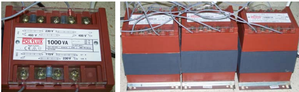
Fig. A.7. Transformadores de acoplamiento
