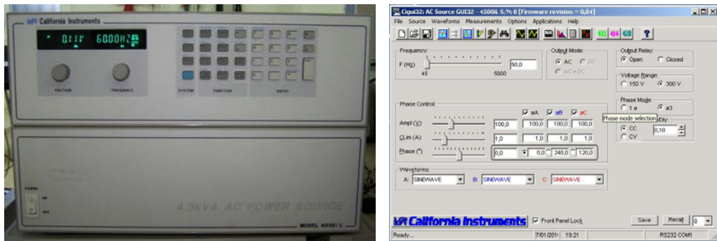
Fig. A.2. Fuente programable modelo 4500iL y software CGUI32 de California Instruments
