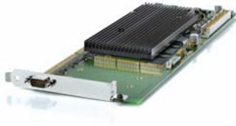
Fig. A.10. Tarjeta de control 1005 PPC de dSPACE
