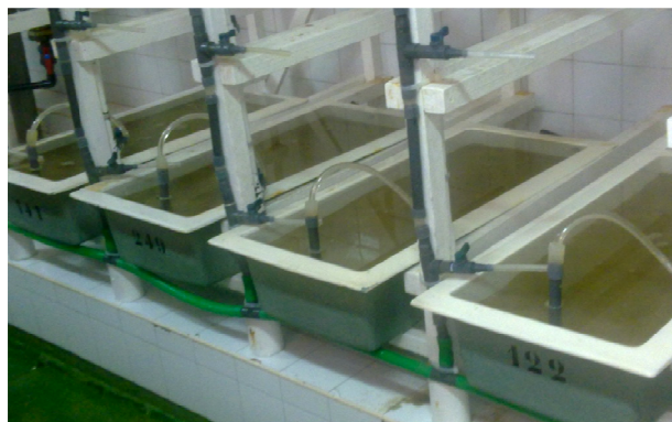
Figura 3.4. Tanques con sustrato de arena para la depuración de las almejas (40 L) en circuito abierto y con alimentación continua.
