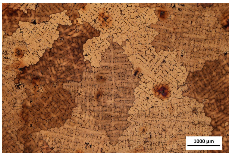
Figura I.23. Imagen de la distribución del grano de Cu en el ánodo dopado DA12.
