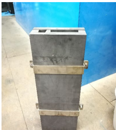
Figura 3.2. Molde diseñado para la fabricación de bloques anódicos dopados (fuente: IME–RWTH).
