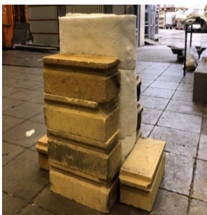
Figura 3.3. Moldeo de los bloques anódicos dopados (fuente: IME–RWTH).
