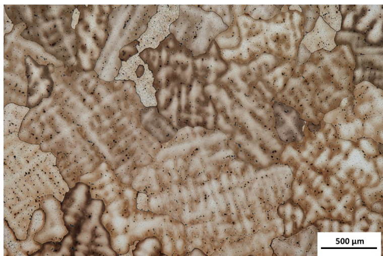
Figura I.19. Imagen de la distribución del grano de Cu en el ánodo dopado DA10.
