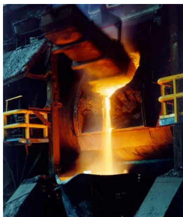
Figura 1.8. Carga de un convertidor (fuente: Atlantic Copper).
