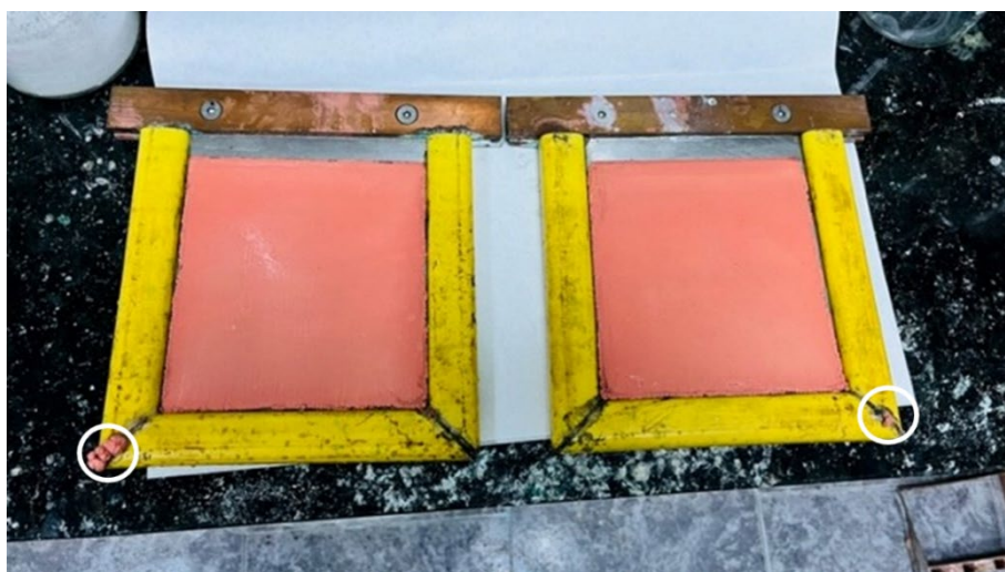
Figura 4.98. Cátodos de Cu generados en el proceso durante el experimento 6. Presencia de Cu depositado en las esquinas inferiores del plástico aislador.
