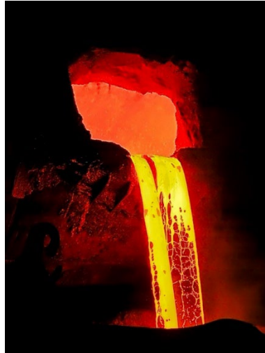
Figura 1.9. Vertido de material desde la boca del convertidor hacia la cuba para su transporte (fuente: Atlantic Copper).
