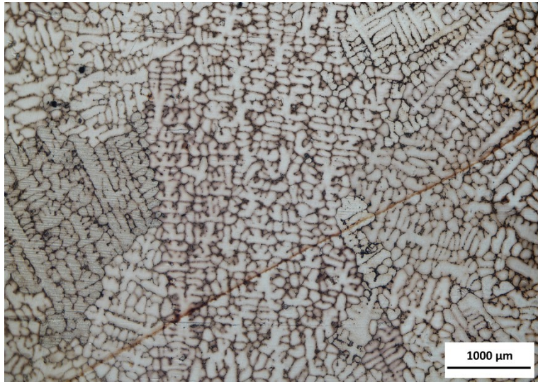
Figura I.3. Imagen la distribución del grano de Cu en el ánodo dopado DA2.
