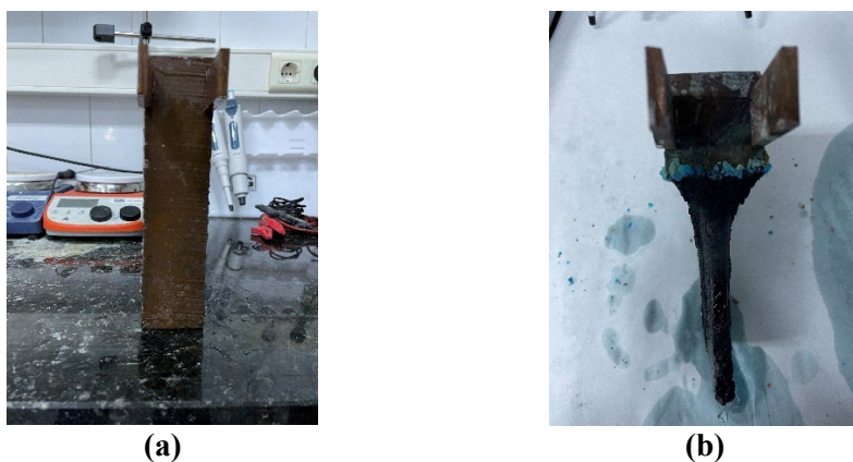
Figura 4.39. (a) vista lateral del ánodo previo al proceso de electrorrefino; (b) vista lateral del ánodo al finalizar el proceso de electrorrefino.
