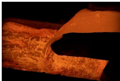
Figura 1.11. Vertido del Cu anódico al molde ubicado en la rueda de moldeo del complejo metalúrgico de AC (fuente: Atlantic Copper).
