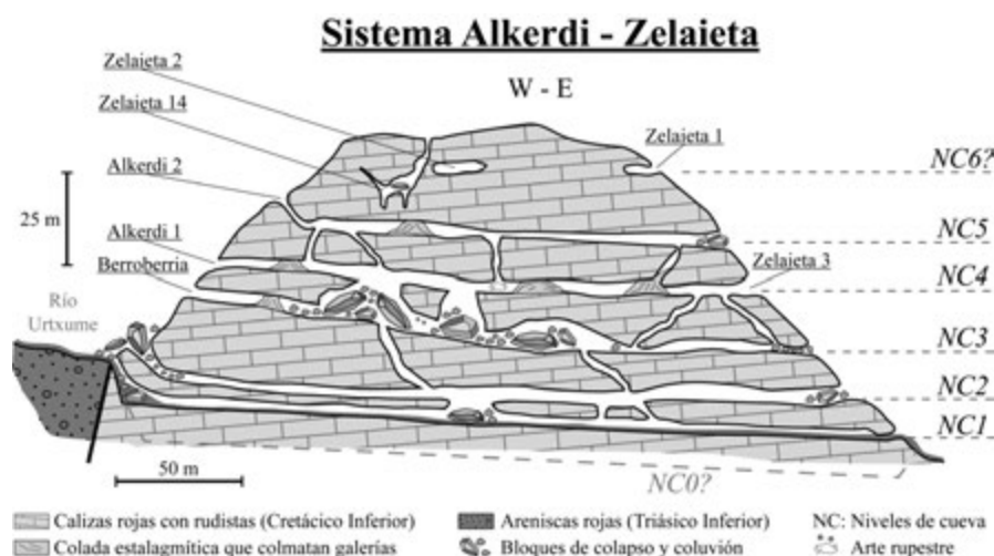
Fig. 3.- Esquema simplificado del desarrollo de los niveles de cueva identificados, con base en la información topográfica de las cavidades del macizo kárstico Alkerdi-Zelaieta y sus geomorfologías freáticas. Ver figura en color en la web.
