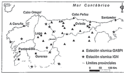
Fig. 3.- Red sísmica temporal (Proyecto GASPI) desplegada en el noroeste peninsular entre 1999 y 2002.
