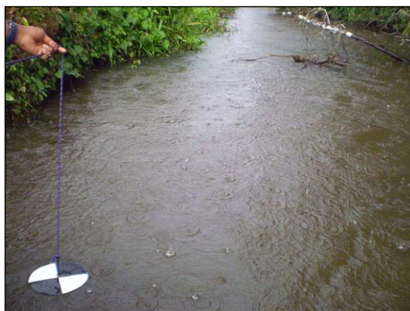
41- Medida de transparencia con disco de Secchi
