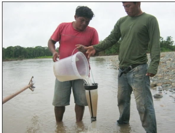
38- Filtrando agua para captar plancton
