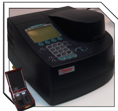
Figura 3. Espectrofotómetro Genesys 10 uv utilizado en el ensayo de captura del radical DPPH • .
