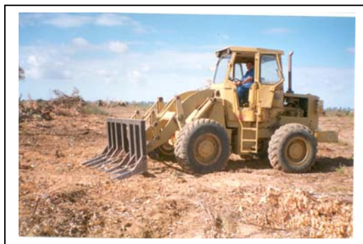
Pala de amontonado.
