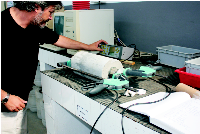
Fig. 59. Acoplamiento de los transductores a la probeta.
