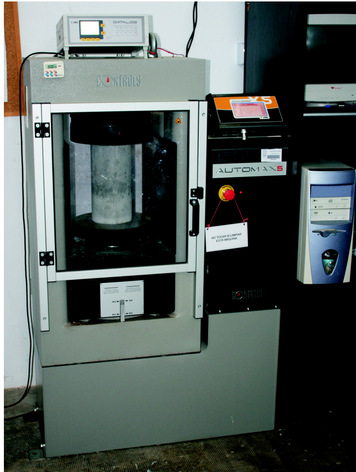
Fig. 60. Prensa utilizada en los ensayos a compresión del hormigón.
