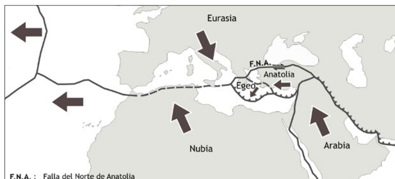
Fig. 2. Los estudios geodésicos ponen de manifiesto cómo la placa de Anatolia se mueve independientemente respecto a Eurasia. Arabia se indenta en la placa Euroasiática a una velocidad de 4 cm/año, expulsando a Anatolia hacia el oeste. Este movimiento hacia el oeste se acomoda por la Falla del Norte de Anatolia que separa Eurasia del resto de Turquía.
