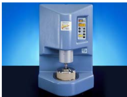
Figura 3.15. Reómetro de esfuerzo controlado Gemini 150 (Bohlin, Inglaterra)
