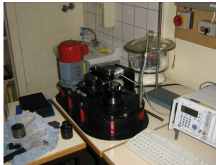
Figura 3.20. Tribómetro del Laboratorio de Tribología en la Universidad de Ciencias Aplicadas de Hamburgo, Alemania
