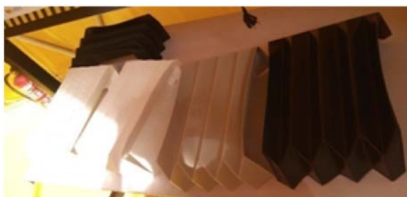
Figura 2. Prototipos fabricados en diferentes materiales termoplásticos del diseño tipo “origami” del módulo de los refugios. Fuente: Elaboración propia.
