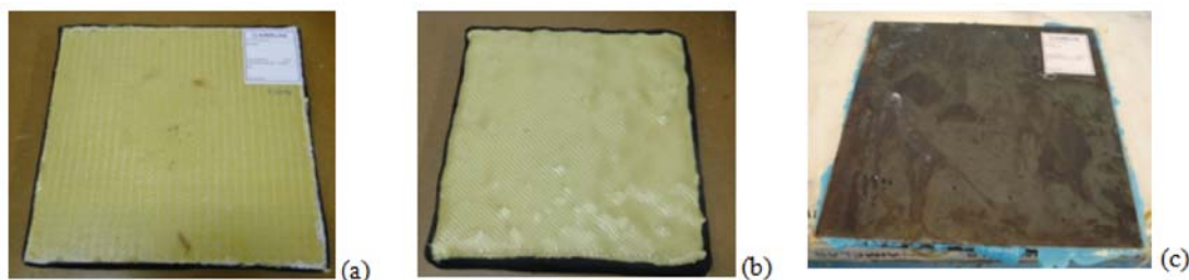
Figura 1. Muestra 2, parte posterior de composite (a) y parte delantera cerámica con 2 capas de fibra de aramida (b), y muestra 5 unida con adhesivo epoxi (c). Fuente: Elaboración propia.
