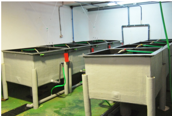
Figura 4.2. Tanques de poliéster (250 L y 0.5 m 2 ), utilizados en los ensayos de identificación de coping style. Cada tanque está dividido en dos habitáculos.
