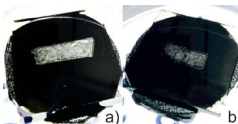
Figura 5. Cultivos deshidratados y preparados para su análisis mediante microscopía SEM: sin dopaje de grafeno (a) y del cultivo dopado con un 1 % w/w de grafeno (b).
