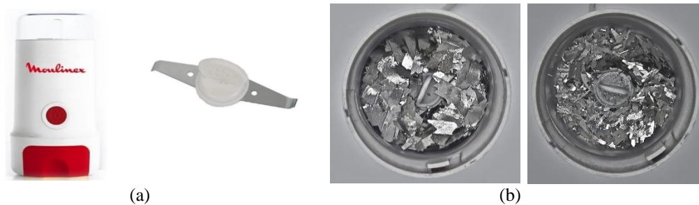
Figura 3.25. (a) Molinillo MC3001 de Moulinex y (b) aspecto de las tiras de Fe 78 -Si 9 -B 13 cortadas manualmente hasta un tamaño de aproximadamente 1 cm, y tras el corte mecánico durante 3 min en el molinillo.
