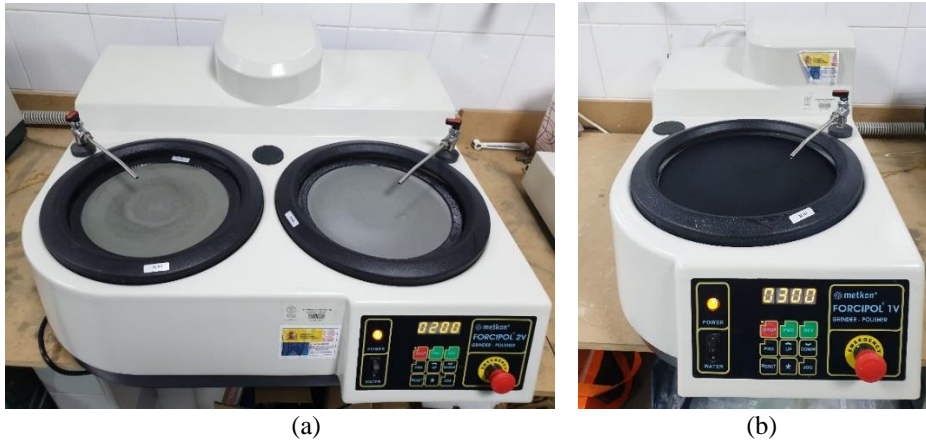
Figura 3.14. (a) Desbastadora Forcipol 2V y (b) pulidora Forcipol 1V, ambas de Metkon.
