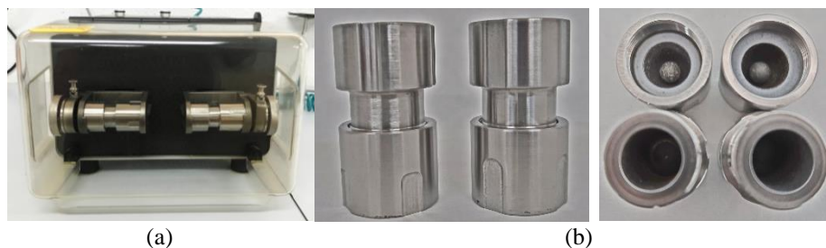
Figura 3.27. Molino de bola vibratorio MM 301: (a) vista general y (b) vasija y bola de WC.
