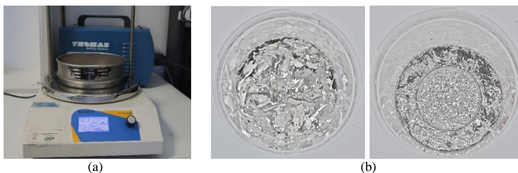
Figura 3.26. (a) Tamizadora electromagnética BA 200 N y (b) resultado de la separación tras vibración durante un minuto con luz de malla de 0.5 mm.
