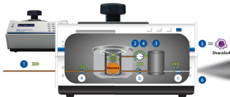
Figura 3.4. Picnómetro automático Accupyc II 1340 (Micromeritics) y esquema del procedimiento de medida.
