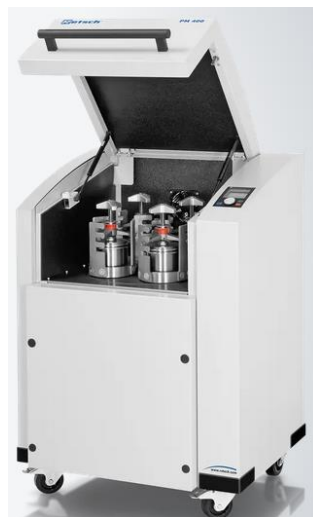
Figura 2.32. Molino de bolas planetario donde se observan los distintos contenedores de polvo.
