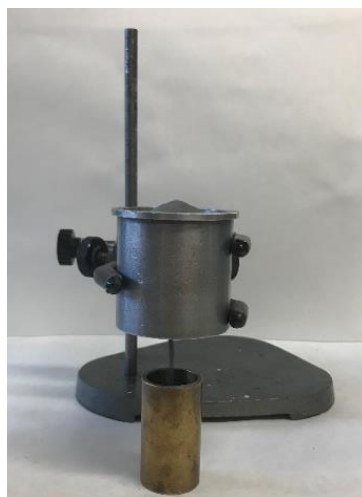
Figura 3.3. Fluidímetro de Hall empleado para la determinación de la fluidez.
