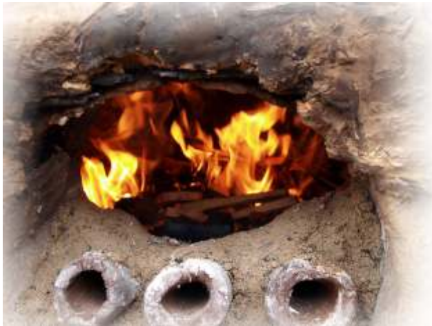
Toberas de Cabezo Juré (Huelva, España) Algaravizes de Cabezo Juré (Huelva, Espanha) Tuyères from Cabezo Juré (Huelva, Spain)
