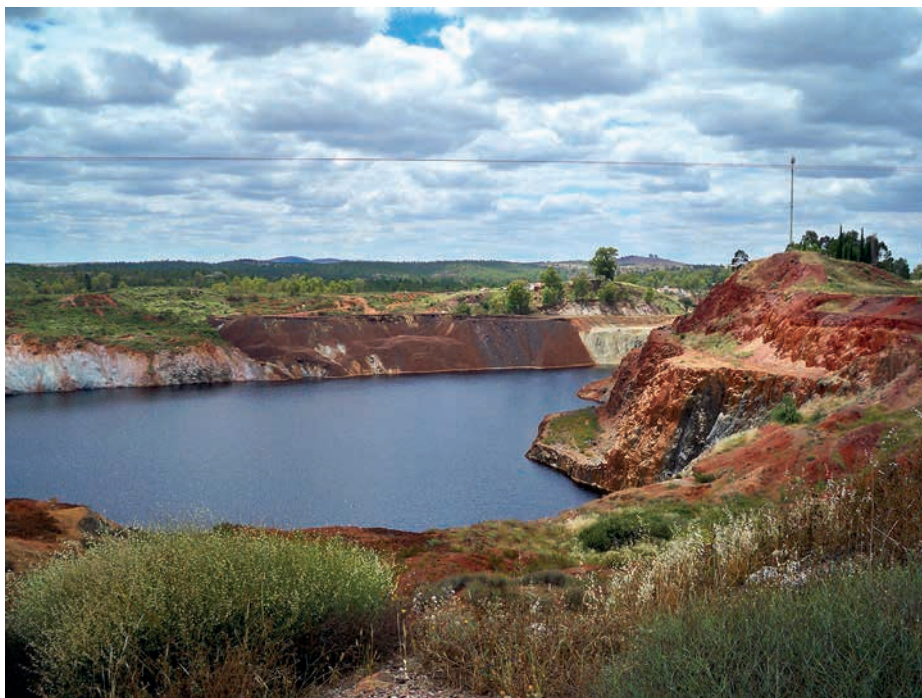
FIGURA 4: Fotografía de la corta de la mina São Domingos inundada de aguas ácidas con elevadas concentraciones de elementos tóxicos
