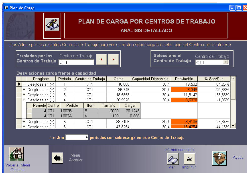
Ilustración 5.24. Pantalla con el Plan de Carga detallado para el Centro de Trabajo CT1 reflejando el desglose de la carga para el periodo 4.
