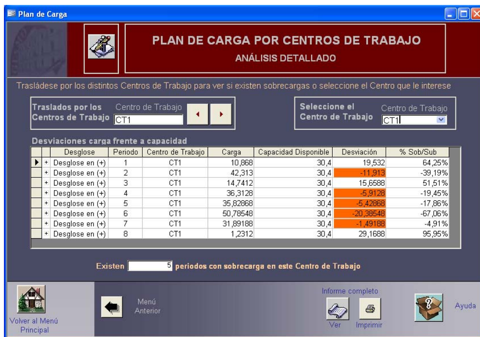
Ilustración 5.25. Pantalla con el Plan de Carga por periodo para el Centro de Trabajo 1, con el modelo propuesto y considerando un aumento del tiempo de ejecución de O1 y O5 de un 5%.
