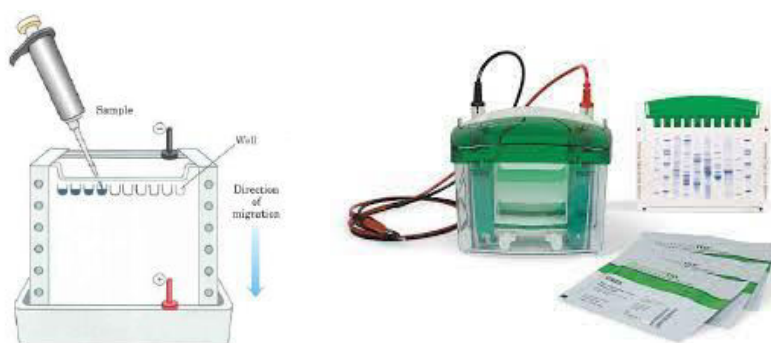
Figura 2.14. Esquema de incorporación de muestra al gel de electroforesis y equipo de electroforesis MiniProtein IV
