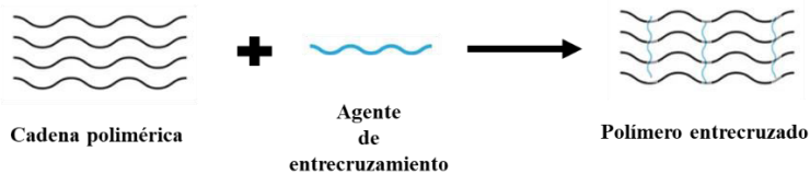
Figura 1.9 Esquema de un proceso de entrecruzamiento químico mediante agente de entrecruzamiento.
