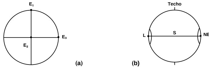
Fig.4.7. Convenio que se ha seguido para la representación de las proyecciones esféricas. (a) Se consideran tres ejes para la descripción de los diagramas de densidad: E_1 ( 0^\circ , 0^\circ ) situado en el norte de la proyección y perpendicularmente al plano de la foliación, E_2 ( 0^\circ , 90^\circ ) en el centro de la proyección, contenido en el plano de foliación y a 90^\circ de la lineación, y E_3 ( 90^\circ , 0^\circ ) situado a la derecha de la proyección, paralelo a la lineación y marcando la referencia geográfica del NE. (b) En todas las proyecciones esféricas de ha considerado el NE geográfico a la derecha de la proyección, el techo en el norte de la misma, la foliación (S) en posición ecuatorial, coincidiendo con la dirección Este-Oeste y vertical, es decir, perpendicular al plano del papel, y la lineación mineral (L) no coincidente exactamente con la intersección del primitivo de la proyección y el plano ecuatorial, sino a un ángulo aproximado de 30^\circ alrededor de éste. Este ángulo de incertidumbre se explica en la fig.3.8.
