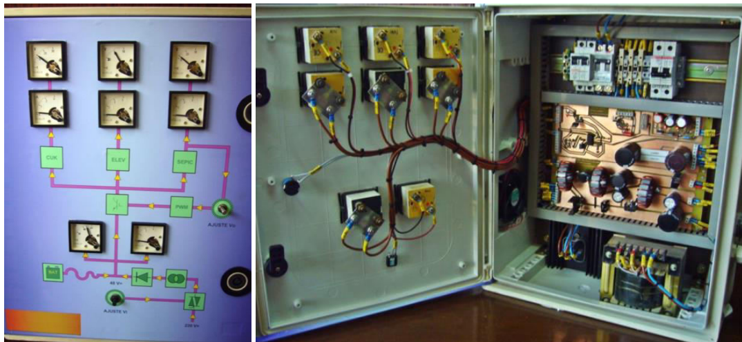
Figura 3.27. Prototipo experimental del convertidor SEPIC-Boost-Ćuk combinado.
