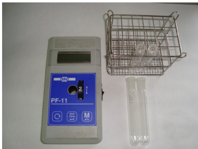
Fotografía 4.6. Fotómetro para análisis de sulfatos.
