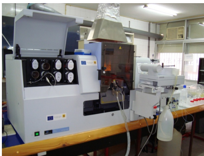
Fotografía 4.7. Absorción Atómica Perkin-Elmer AAS (AAAnalyst 800).
