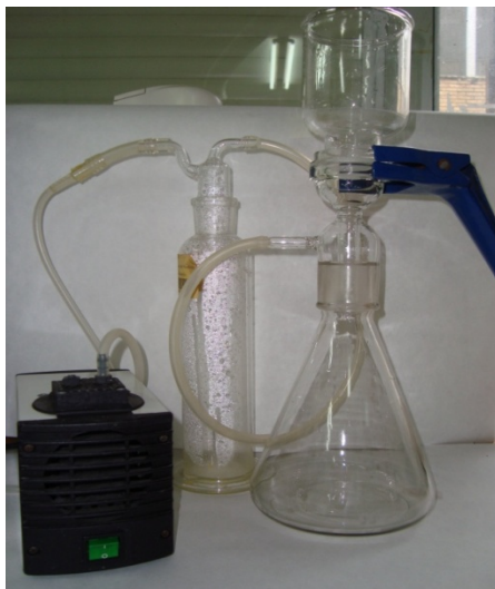
Fotografía 4.5. Sistema de filtración con quitasatos de vidrio.
