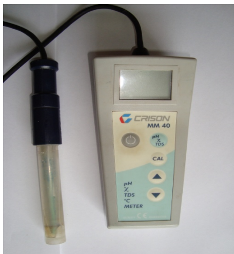
Fotografía 4.3. Equipo multiparamétrico Crison MM40.
