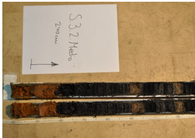
Fotografía 4.8. Testigo de uno de los sondeos realizados en el embalse Marismillas.
