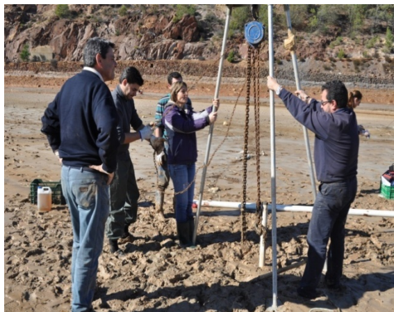
Fotografía 4.1. Campaña de sondeos con recuperación de testigo realizada en el embalse Marismillas en Noviembre de 2011.
