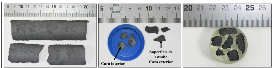
Figura 3.8. Preparación de muestras del material arrastrado por los gases del HF muestreadas con la barra de acero.
