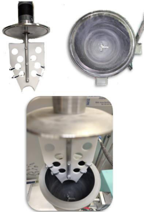
Figura 48. Arriba Izqda: sistema de agitación interior de la tolva. Dcha: tolva teflonada en su interior. Abajo, sistema de agitación completo.
