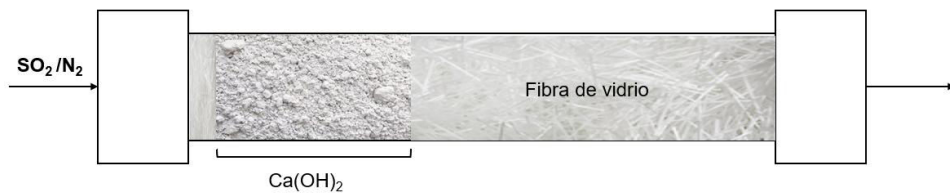
Figura 43. Empaquetado de la columna de 25 cm del lecho fijo con \text{Ca}(\text{OH})_2 y material inerte (fibra de vidrio).
