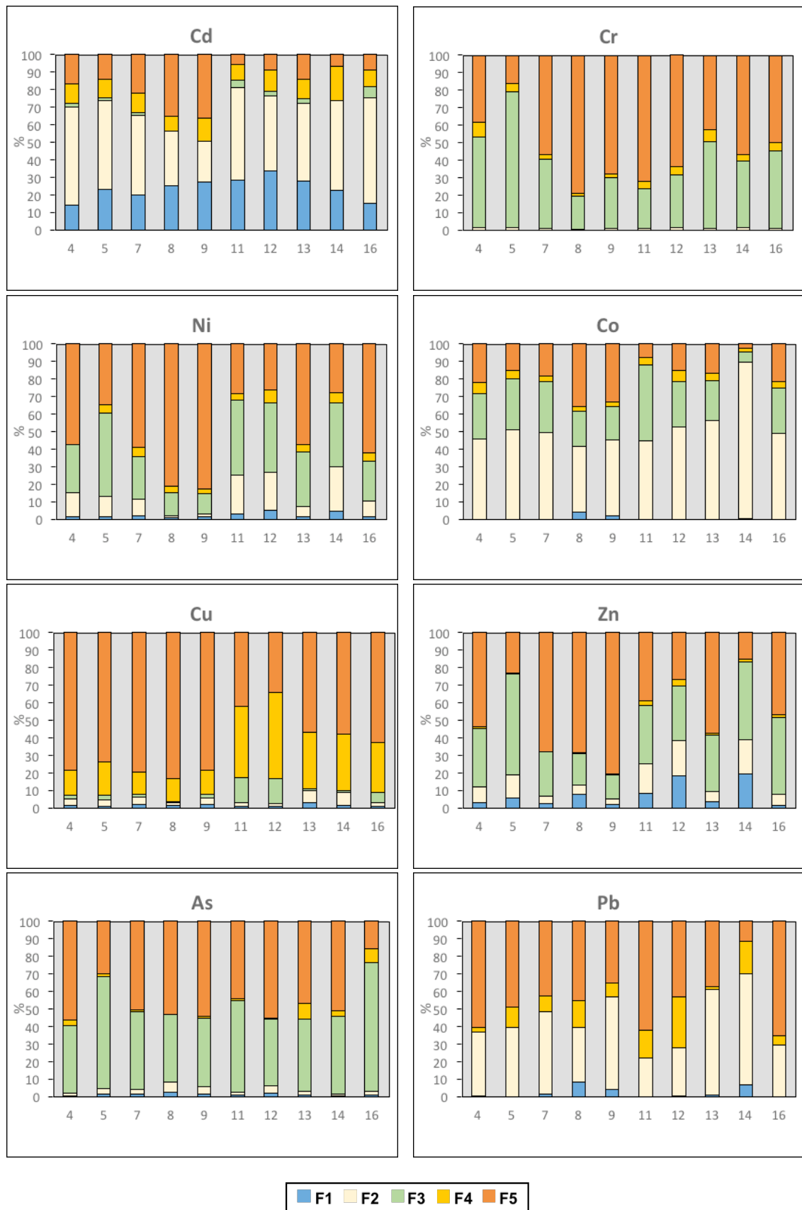
Figura 31. Reparto de elementos traza (en % extraído) entre las fracciones operacionalmente definidas en el procedimiento de extracción secuencial: F1 (intercambiable/soluble en ácido); F2 (reducible I); F3 (reducible II); F4 (oxidable); F5 (residual).
