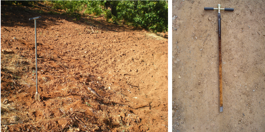
Figura 10. Muestreo de los suelos con barrena manual Edelman (izquierda) y sonda sacatestigos (derecha) de la firma Eijkelkamp.
