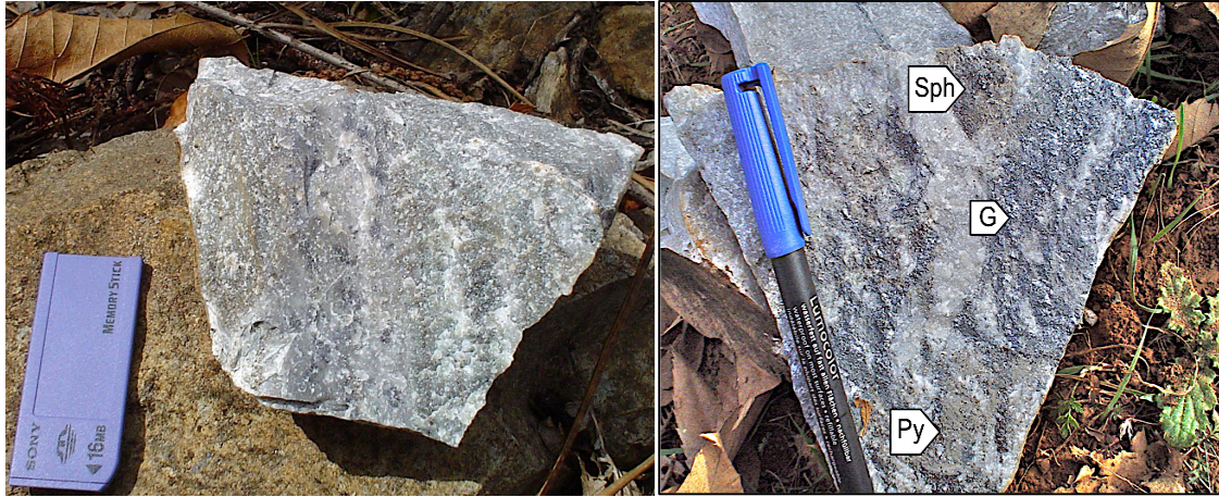
Figura 12. Aspecto de las dolomías marmóreas en muestra de roca fresca (izquierda), y de la mineralización de sulfuros metálicos estratoligada (derecha). Abreviaturas: G (galena), Py (pirita), Sph (esfalerita).
