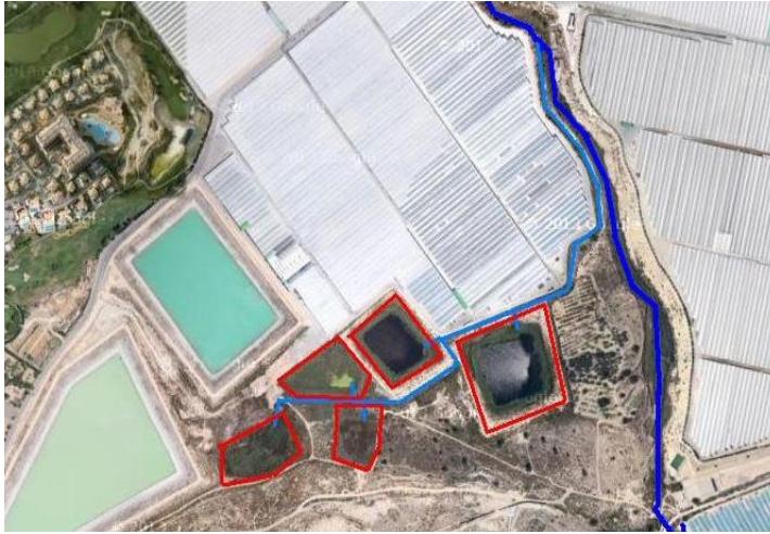
Figura 4. “Basses de Bonny”. Sistema de recogida de pluviales para riego por parte de la empresa agrícola Bonnysa en el “Barranc del Fondó” (Mutxamel). Fuente: Morote, 2014.
